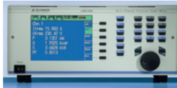
**Das Betriebsmessgerät LMG450 ist für die Leistungsmessung elektronischer Verbraucher sowie Frequenz- und Wechselrichter geeignet.**
